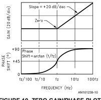
FIGURE 10. ZERO GAIN/PHASE PLOT
