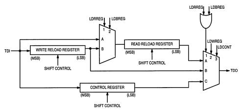
THE LEFT MOST CONTROL SIGNAL ENTERING THE MUX FROM THE TOP(1) SELECTS THE UPPER MOST INPUT ON THE LEFT SIDE OF THE MUX(A). THE RIGHT MOST CONTROL SIGNAL SELECTS THE BOTTOM MOST INPUT.
