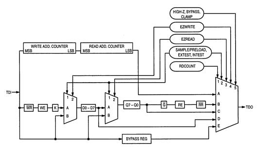
THE LEFT MOST CONTROL SIGNAL ENTERING THE MUX FROM THE TOP(1) SELECTS THE UPPER MOST INPUT ON THE LEFTSIDE OF THE MUX(A). THE RIGHT MOST CONTROL SIGNAL SELECTS THE BOTTOM MOST INPUT.
