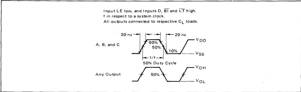
FIGURE 2 – DYNAMIC SIGNAL WAVEFORMS
