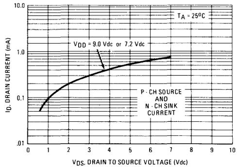
FIGURE 3 — TYPICAL P HORN DRIVER OUTPUT I-V CHARACTERISTIC
