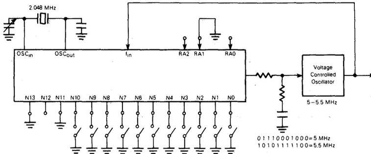
FIGURE 7 — SYNTHESIZER FOR LAND MOBILE RADIO UHF BANDS
