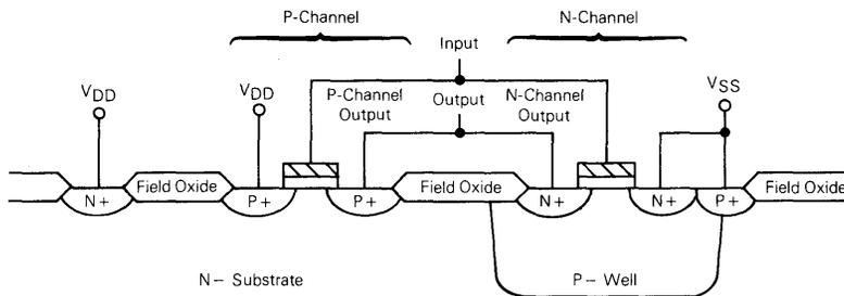
FIGURE 4 — LATCH UP CIRCUIT SCHEMATIC
