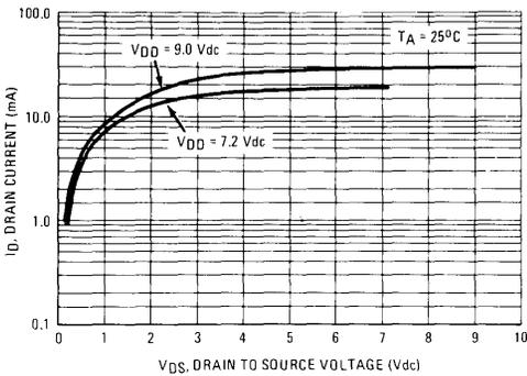
**FIGURE 3 – TYPICAL COMPARATOR OUTPUT I-V CHARACTERISTIC**
