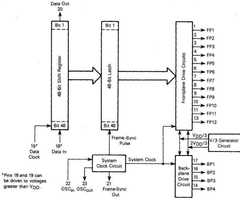
FIGURE 2 — BLOCK DIAGRAM OF THE MC145001 (SLAVE) LCD DRIVER
