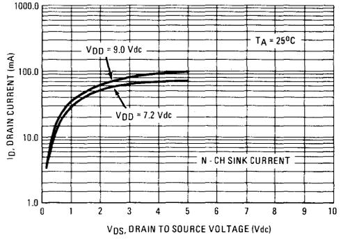
FIGURE 5 – TYPICAL COMPARATOR OUTPUT I-V CHARACTERISTIC
