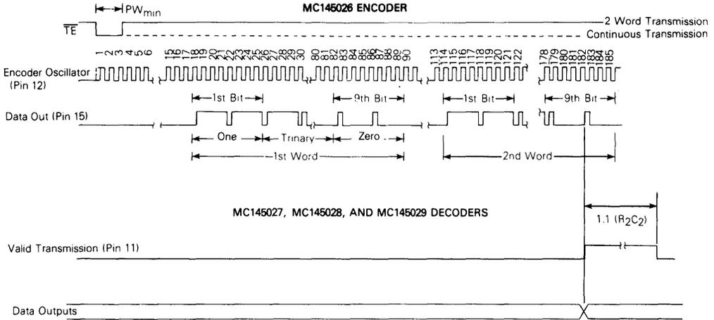
FIGURE 7 — MC145026 ENCODER DATA WAVEFORMS
