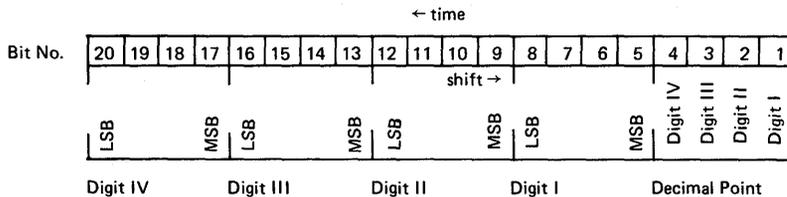
FIGURE 3a – SERIAL INPUT, POSITIVE CLOCK
