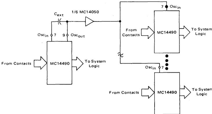
FIGURE 9 – SINGLE PULSE OUTPUT CIRCUIT
