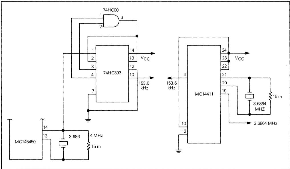
FIGURE 3 — CLOCK CIRCUITS
