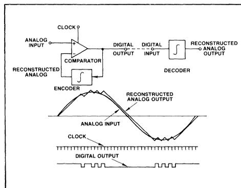
**FIGURE 1 — SIMPLE DELTA MODULATION**
