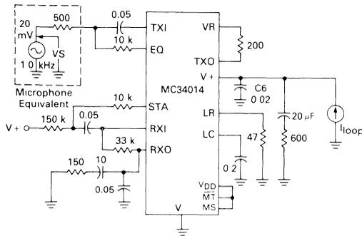
FIGURE 4 — AC IMPEDANCE, RECEIVE AND SIDETONE CANCELLATION TEST
