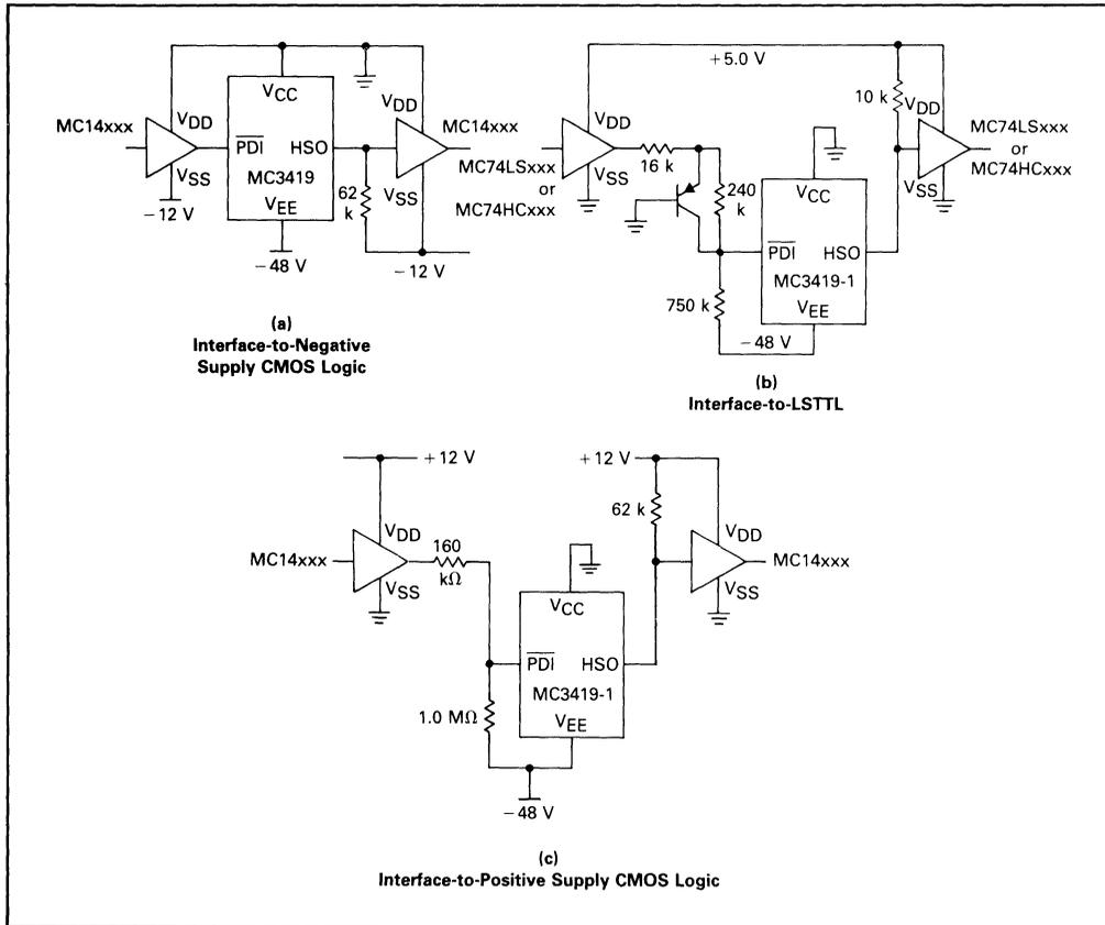
FIGURE 15 — PBX LINE CIRCUIT
