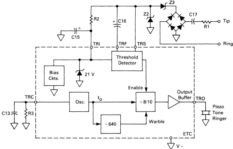
FIGURE 8 — MICROPROCESSOR INTERFACE BLOCK DIAGRAM (MC34010A ONLY)
