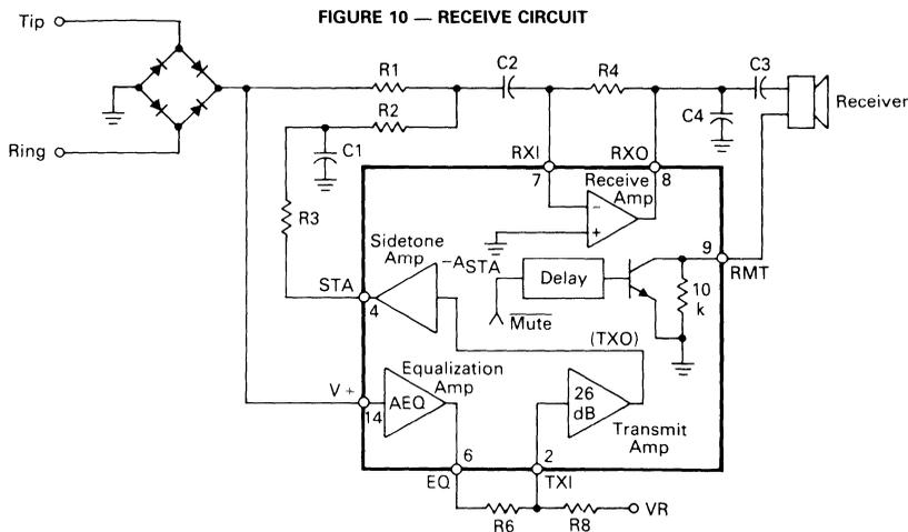
FIGURE 10 — RECEIVE CIRCUIT
