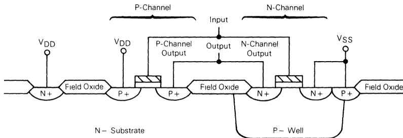
FIGURE 4 — LATCH UP CIRCUIT SCHEMATIC
