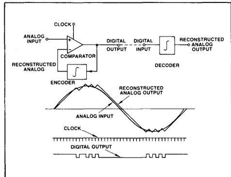
FIGURE 1 — SIMPLE DELTA MODULATION
