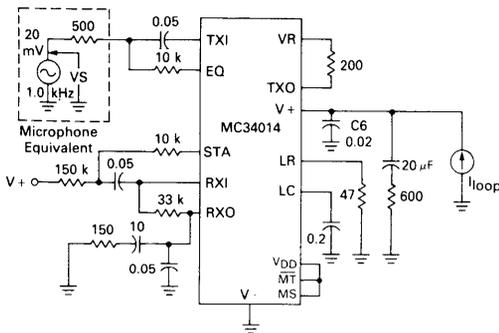
FIGURE 4 — AC IMPEDANCE, RECEIVE AND SIDETONE CANCELLATION TEST
