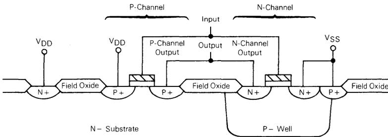
FIGURE 4 — LATCH UP CIRCUIT SCHEMATIC
