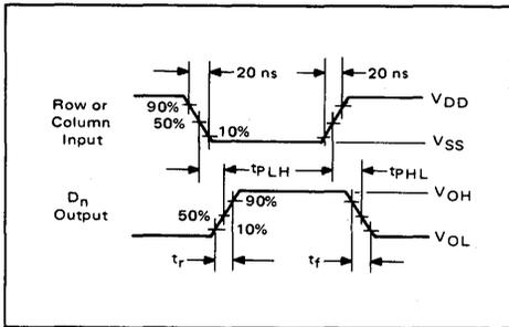
FIGURE 2 – TYPICAL STROBE PULSE DELAY TIMES
