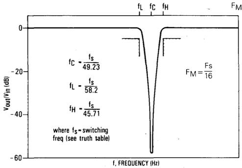
FIGURE 3 — TYPICAL BAND-PASS FILTER RESPONSE CURVES
