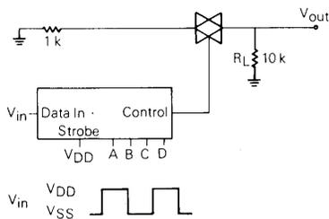
FIGURE 6 — CHANNEL RESISTANCE ( $R_{ON}$ ) TEST CIRCUIT
