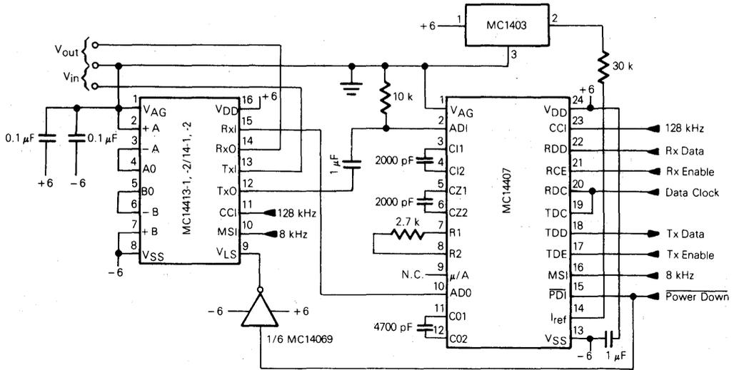
FIGURE 8 — TYPICAL CIRCUIT CONFIGURATION
