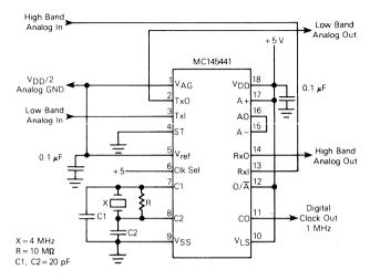
FIGURE 1 - TEST CIRCUIT
