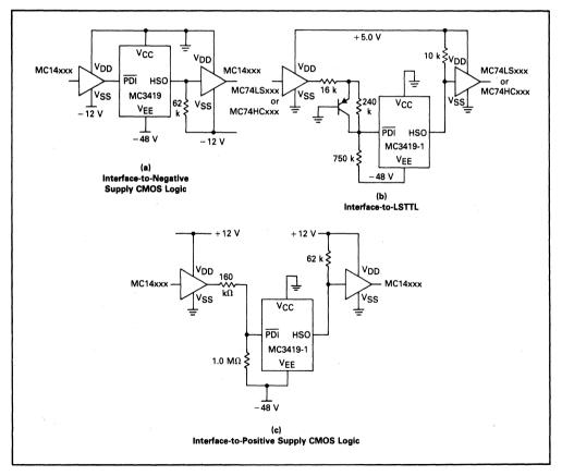
FIGURE 15 - PBX LINE CIRCUIT
