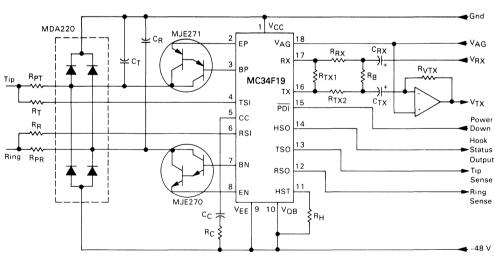
FIGURE 7 - SLIC CIRCUIT
