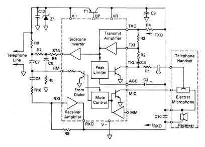
FIGURE 4 — SPEECH NETWORK BLOCK DIAGRAM
