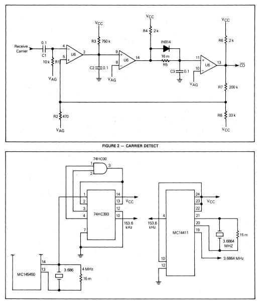
FIGURE 3 - CLOCK CIRCUITS
