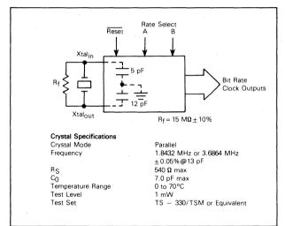
FIGURE 2 - TYPICAL CRYSTAL OSCILLATOR CIRCUIT
