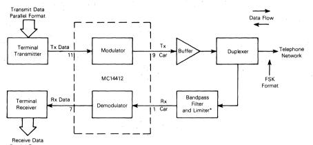
FIGURE 1 - TYPICAL LOW-SPEED MODEM APPLICATION
