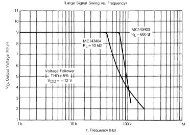
FIGURE 2 - TYPICAL POWER BANDWIDTH
