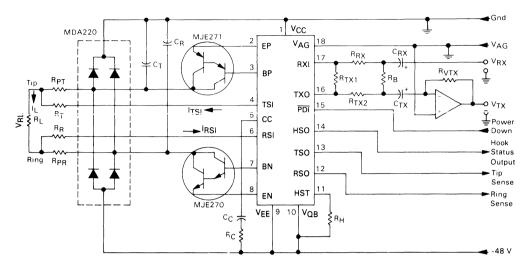
FIGURE 7 - BASIC SLIC CIRCUIT
