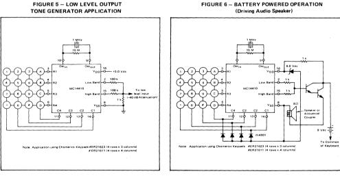
FIGURE 6 - BATTERY POWERED OPERATION
