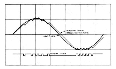
FIGURE 12 - CVSD WAVEFORMS
