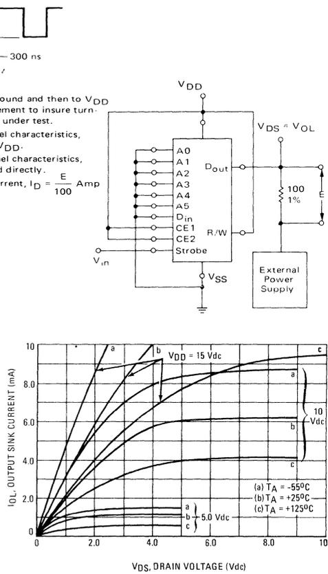
FIGURE 7 - FUNCTIONAL CIRCUIT DIAGRAM
