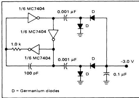
FIGURE 26 – GATE VOLTAGE CHARGE PUMP SUPPLY
