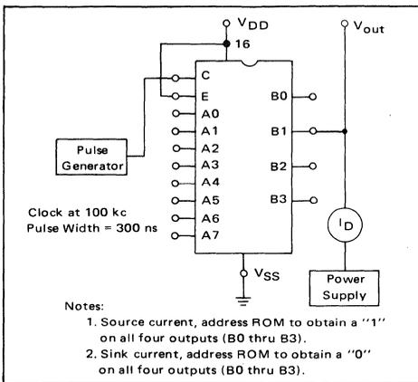
FIGURE 2 — SWITCHING TIME TEST CIRCUIT
