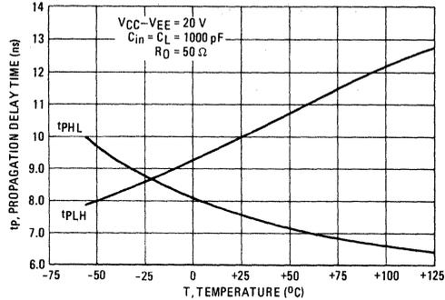
FIGURE 10 – TRANSITION TIMES versus TEMPERATURE
