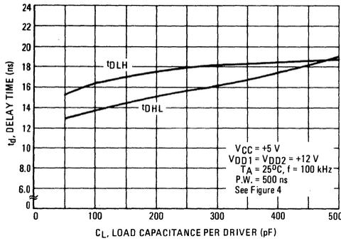
FIGURE 10 – TRANSITION TIMES versus LOAD CAPACITANCE (REFRESH MODE)
