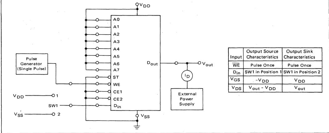
FIGURE 2 – POWER DISSIPATION TEST CIRCUIT AND WAVEFORMS
