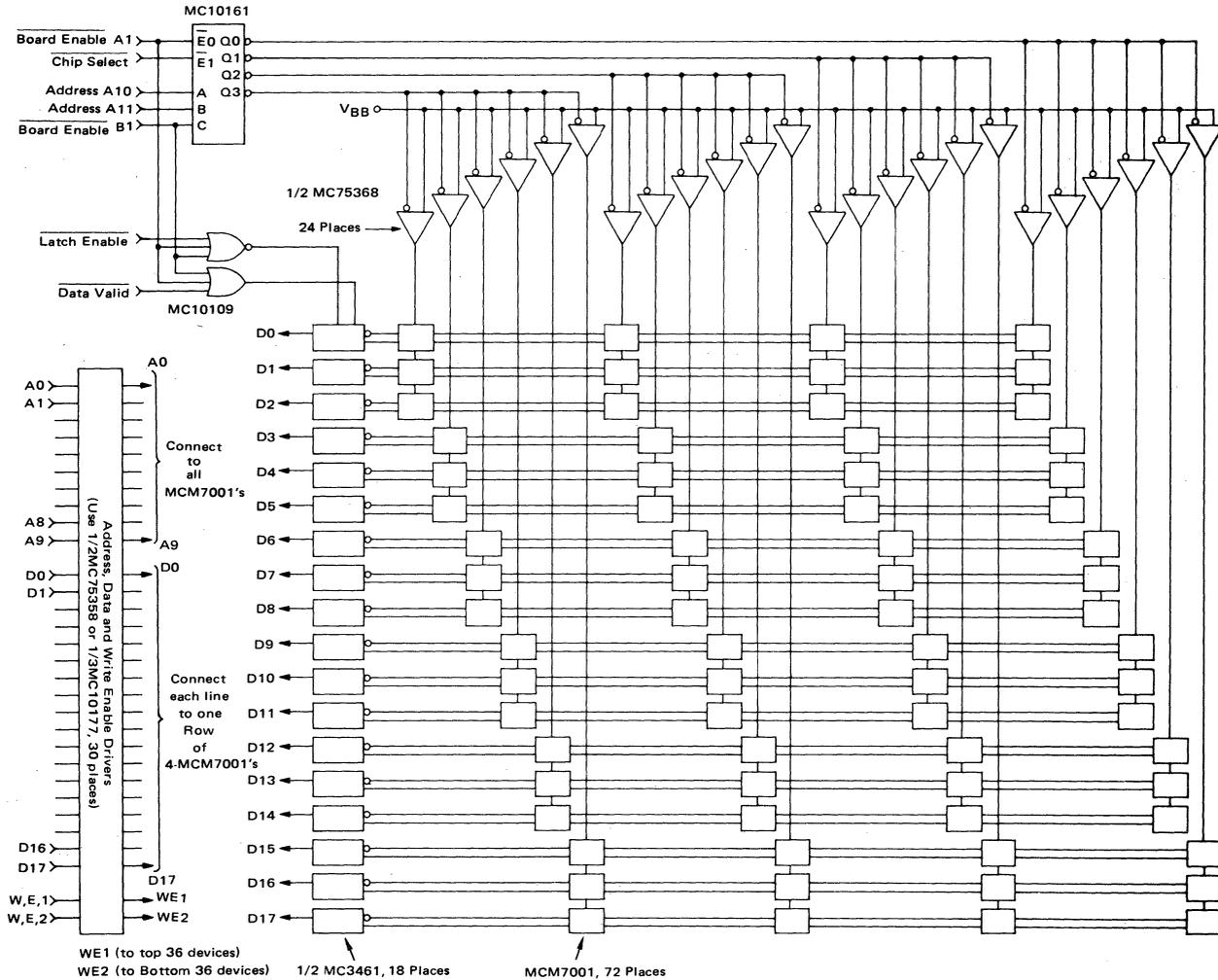
FIGURE 9 - 4K x 18 MEMORY BOARD (MECL SYSTEM)
