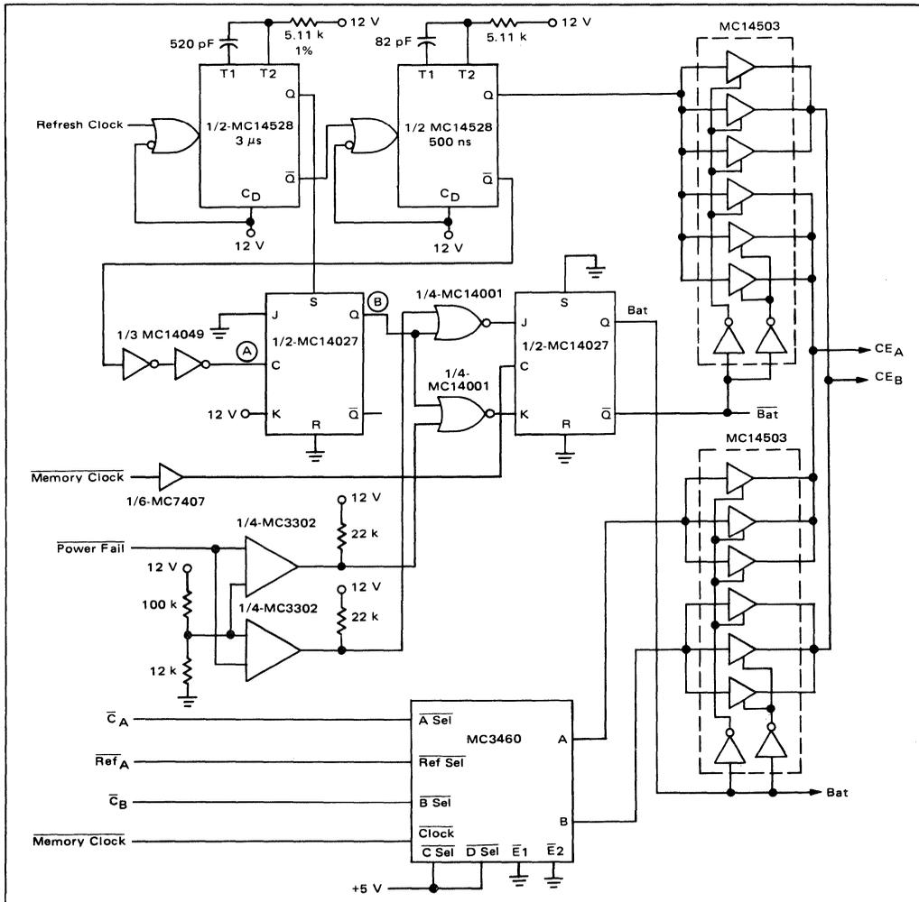
FIGURE 18 – POWER UP/DOWN SYNCHRONIZATION
