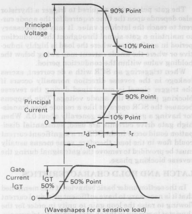
**FIGURE 6 — WAVESHAPES ILLUSTRATING THYRISTOR TURN-ON TIME FOR A RESISTIVE LOAD**
