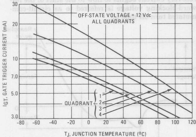
FIGURE 4 — TYPICAL TRIAC TRIGGERING SENSITIVITY IN THE FOUR TRIGGER QUADRANTS
