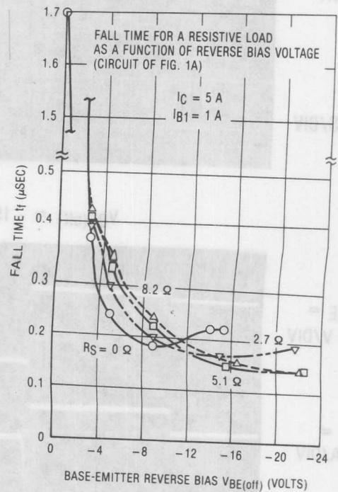
**FIGURE 5(E) — FALL TIME OF THE 2N6250 WITH VARIABLE REVERSE BASE CURRENT. RESISTIVE LOAD**
