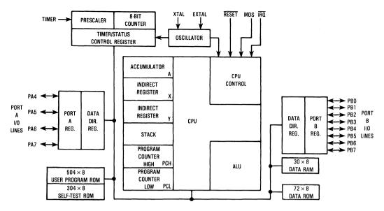
Figure A-1. MC6804J1 Block Diagram
