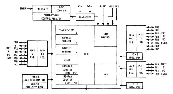
Figure 1-1. MC6804P2 Block Diagram
