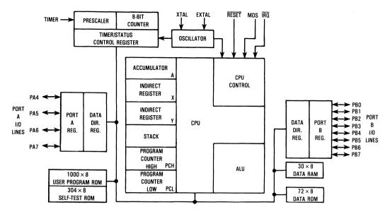
Figure B-1. MC6804J2 Block Diagram
