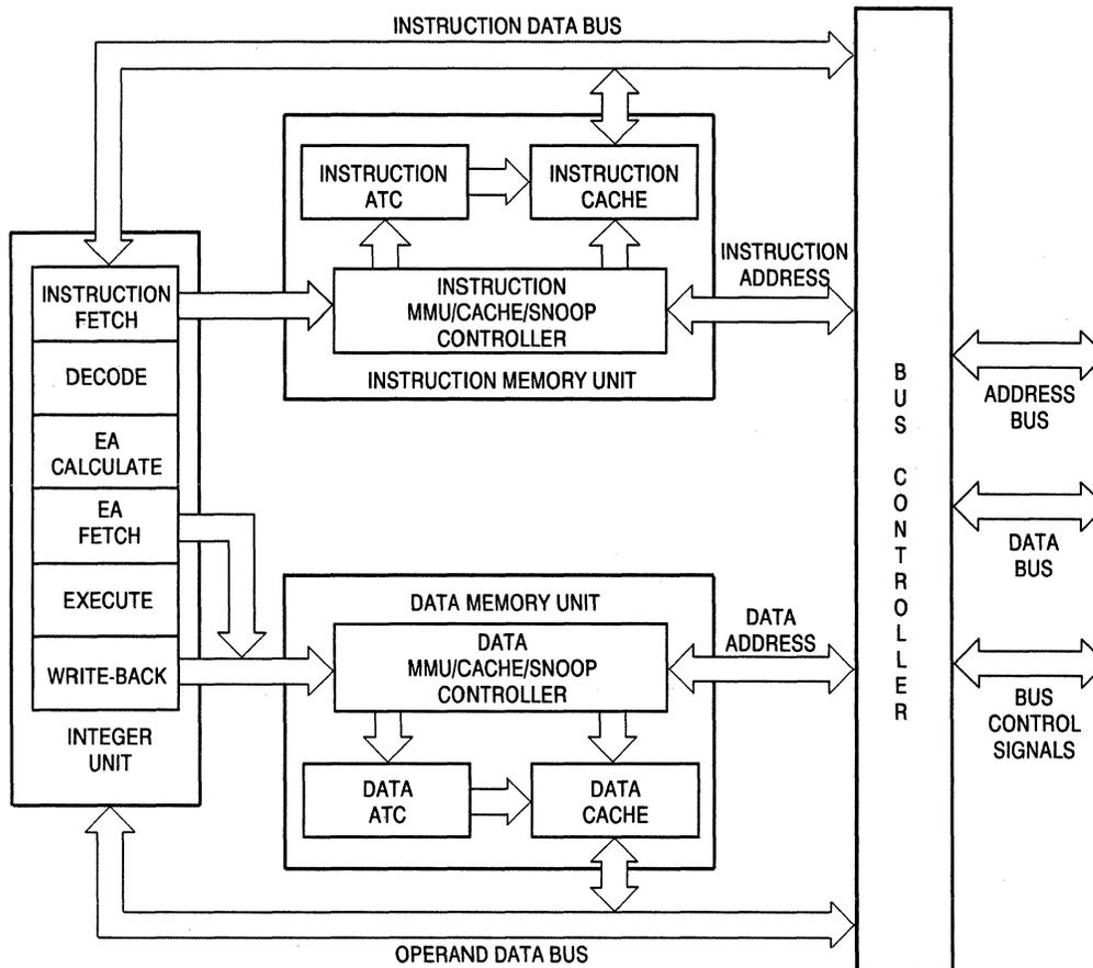
**Figure 1. MC68LC040 Block Diagram**
