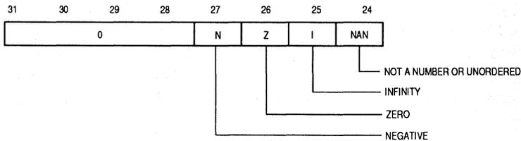
Figure 2-5. FPSR Condition Code Byte
