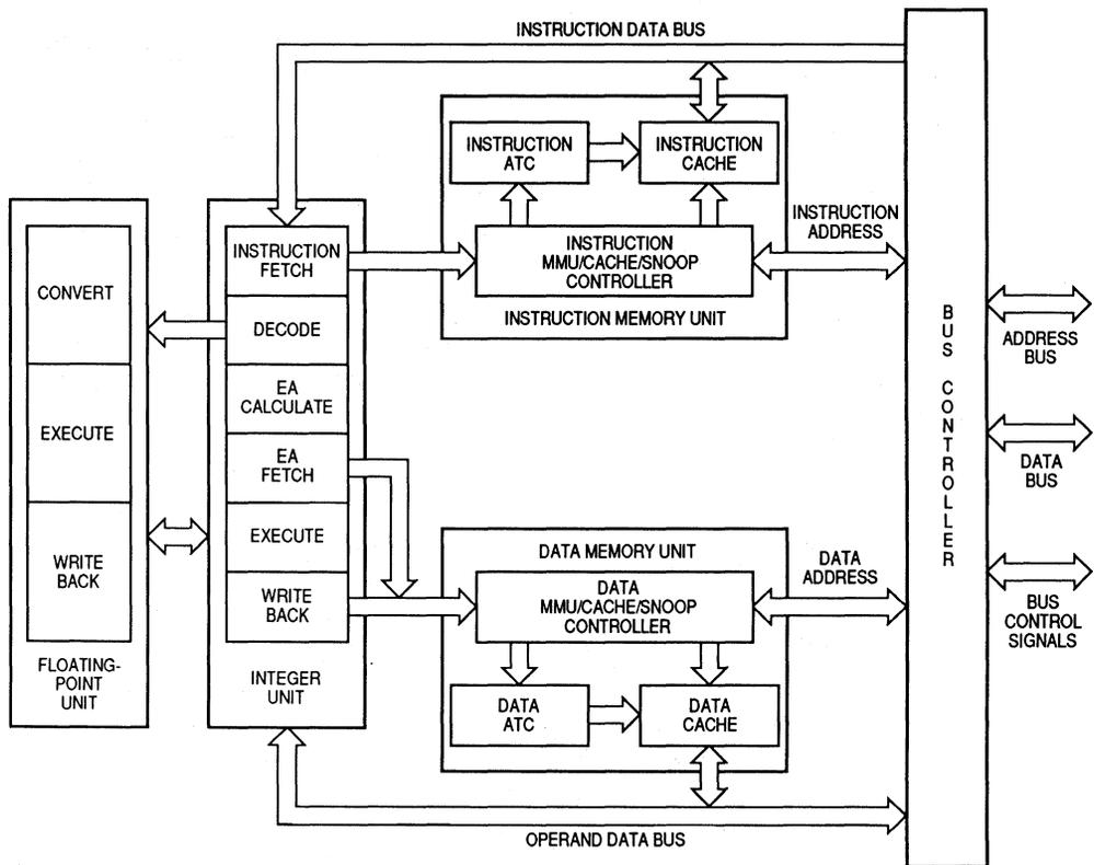
Figure 1-1. MC68040 Block Diagram
