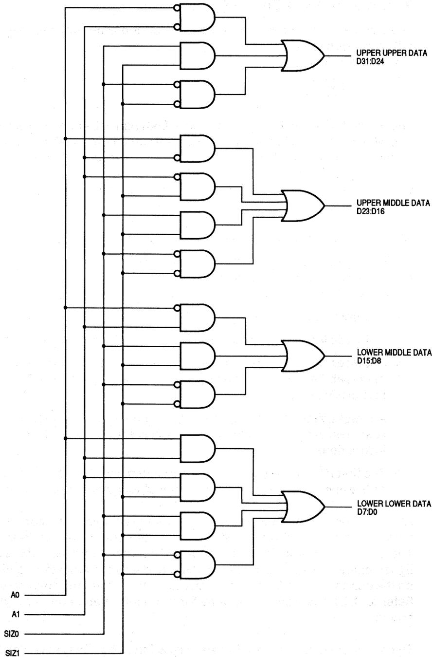
Figure 8-7. Byte Data Select Generation
