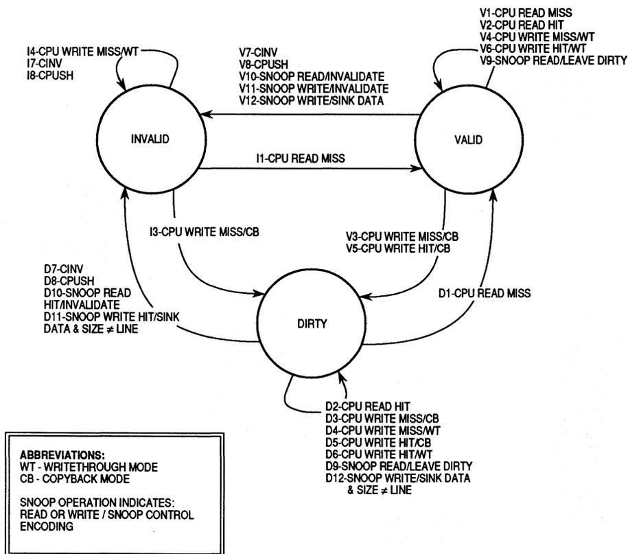
**Figure 7-6. Data-Cache-Line State Diagram**
