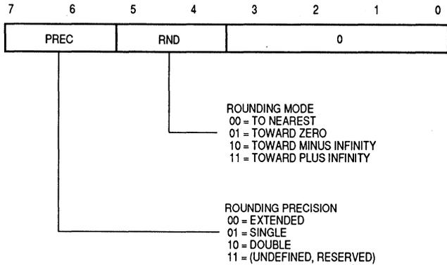
Figure 2-4. FPCR Mode Control Byte
