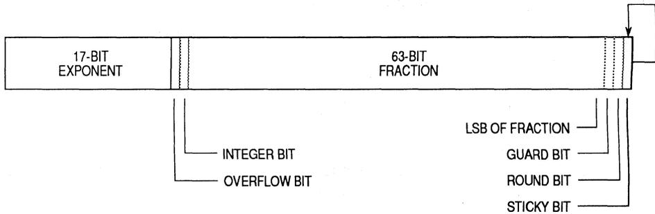
**Figure 3-9. Intermediate-Result Format**
