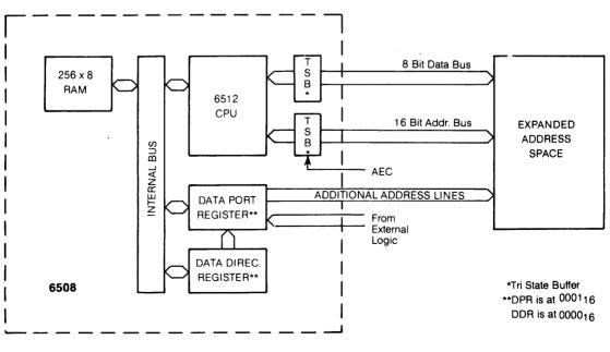
MPS 6508 — EXPANDED MEMORY CONFIGURATION
