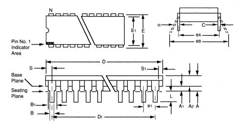
13.2 PACKAGE TYPE: 40-LEAD PLASTIC DUAL IN-LINE (.600 MIL)
