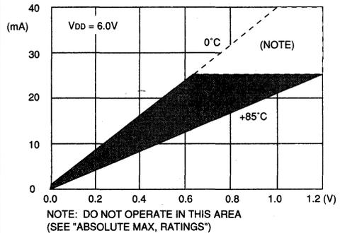
**FIGURE 17: I<sub>OH</sub> vs. V<sub>OH</sub>**
