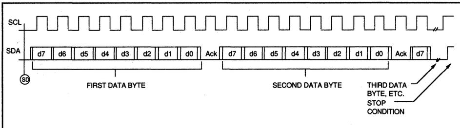
Fig. 3B Byte Write Sequence
