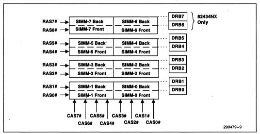
Figure 8. SIMMs and Corresponding DRB Registers
