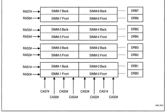
Figure 2. SIMMs and Corresponding DRB Registers
