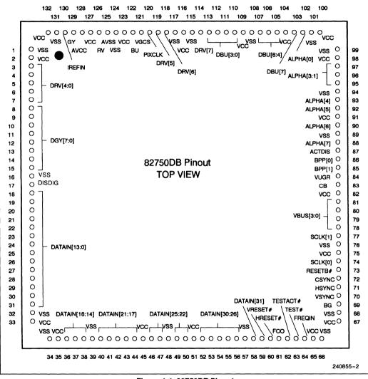
Figure 1-1. 82750DB Pinout
