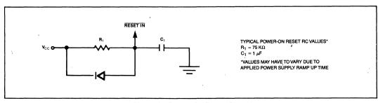
Figure 3. Power-On Reset Circuit
