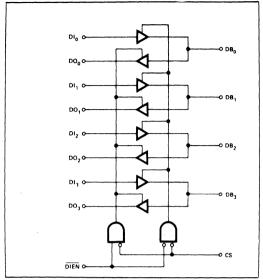
Figure 3a. 8216 Logic Diagram
