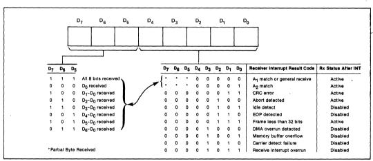
Figure 10. Rx Interrupt Result Byte Format
