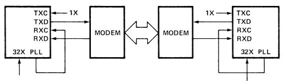
ASYNCHRONOUS MODEMS – HALF DUPLEX OPERATION
