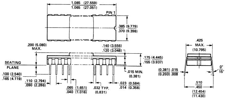
**24-LEAD HERMETIC DUAL IN-LINE PACKAGE TYPE B**
