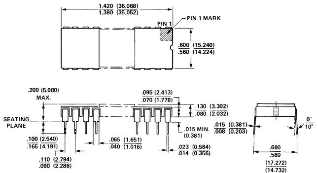
**40-LEAD HERMETIC DUAL IN-LINE PACKAGE TYPE C**
