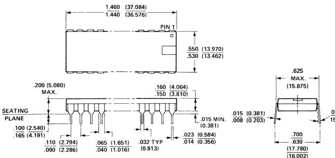
40-LEAD PLASTIC DUAL IN-LINE PACKAGE TYPE P
