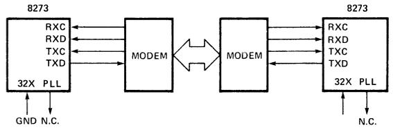
ASYNCHRONOUS MODEMS – DUPLEX OPERATION
