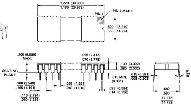
**28-LEAD HERMETIC DUAL IN-LINE PACKAGE TYPE C**
