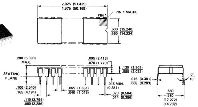
**CERAMIC DUAL IN-LINE PACKAGE TYPE B**
