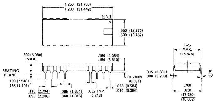
28-LEAD PLASTIC DUAL IN-LINE PACKAGE TYPE P
