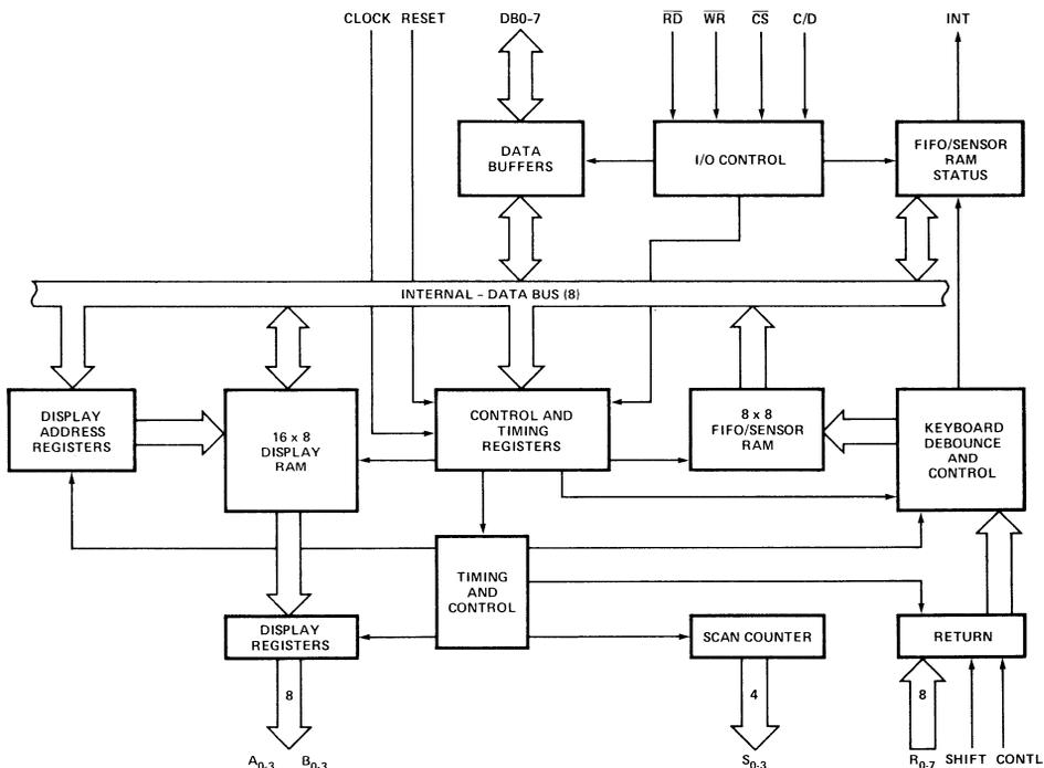
FIGURE 1. 8279 BLOCK DIAGRAM
