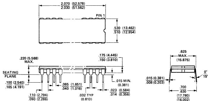
**CERAMIC DUAL IN-LINE PACKAGE TYPE C**
