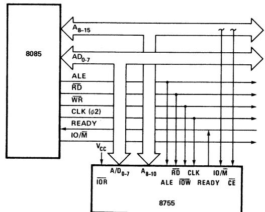
FIGURE 3. 8755 IN 8085 SYSTEM (MEMORY-MAPPED I/O).
