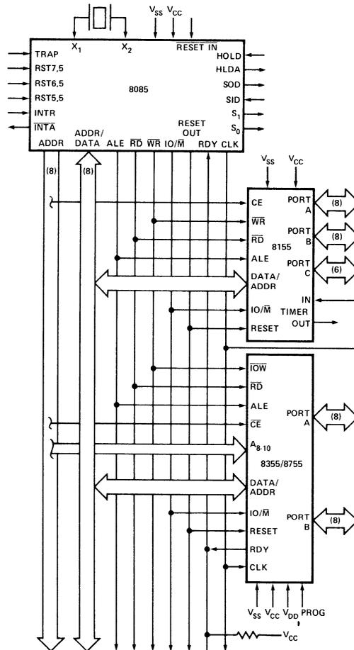
FIGURE 6. 8085 MINIMUM SYSTEM (STANDARD I/O TECHNIQUE)
