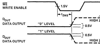
2125 FAMILY PROPAGATION DELAY FROM CHIP SELECT TO HIGH Z
