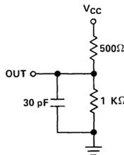
**CAPACITANCE<sup>(2)</sup>  $T_A = 25^\circ\text{C}$**
