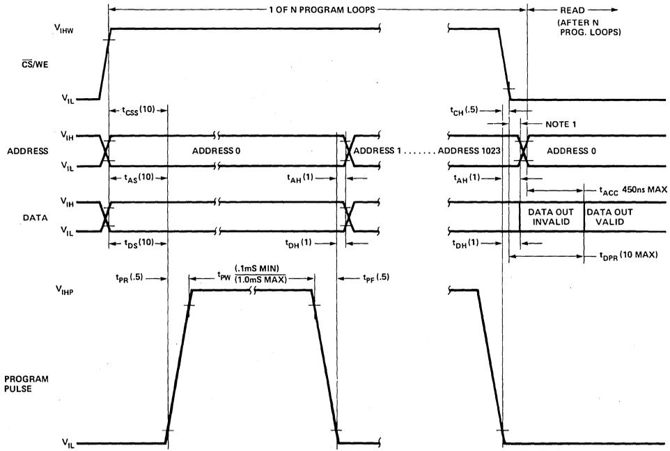
NOTE 1. THE CS/WE TRANSITION MUST OCCUR AFTER THE PROGRAM PULSE TRANSITION AND BEFORE THE ADDRESS TRANSITION.
