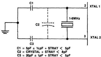
CRYSTAL SERIES RESISTANCE SHOULD BE LESS THAN 75Ω AT 6MHz; LESS THAN 180Ω AT 3.6MHz.
