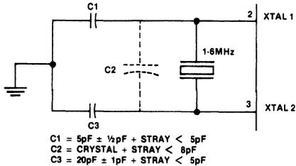
CRYSTAL SERIES RESISTANCE SHOULD BE LESS THAN  $75\Omega$  AT 6MHz; LESS THAN  $180\Omega$  AT 3.8MHz.
