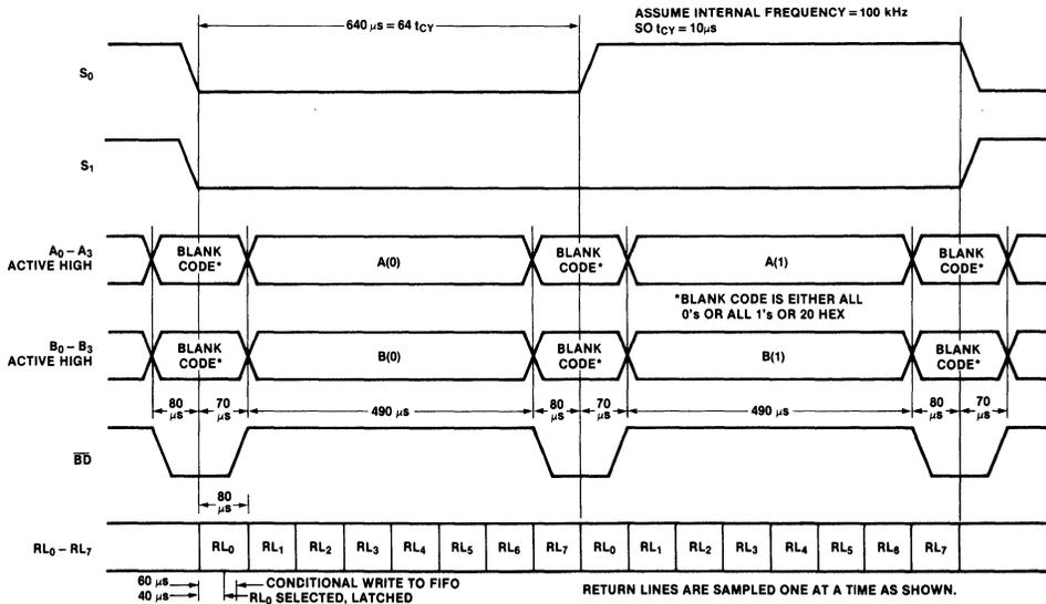
NOTE: SHOWN IS ENCODED SCAN LEFT ENTRY
