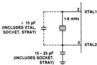
CRYSTAL SERIES RESISTANCE SHOULD BE  $< 75\Omega$  AT 6 MHz;  $< 180\Omega$  AT 3.6 MHz.
