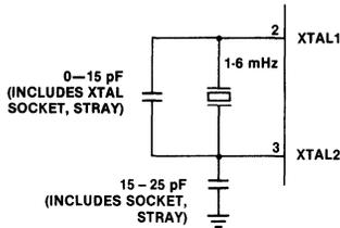
CRYSTAL SERIES RESISTANCE SHOULD BE <75Ω AT 6 MHz; <180Ω AT 3.6 MHz.
