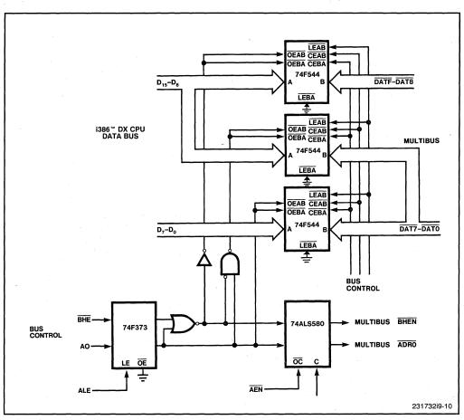
Figure 9-10. Byte-Swapping Logic
