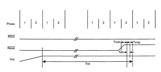
Figure 13. Power-On Reset Timing
