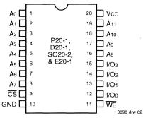
DIP/SOIC/SOJ/CERPACK TOP VIEW
