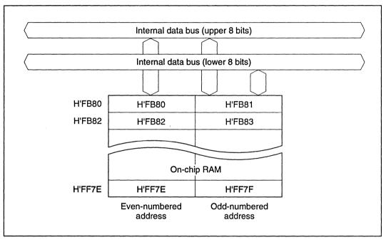
Figure 7-1 RAM Block Diagram (H8/3834)
