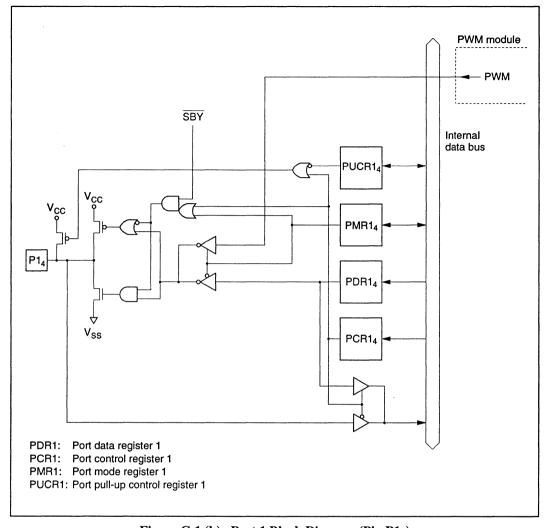
$Figure \ C\text{-}1\ (b) \quad Port\ 1\ Block\ Diagram\ (Pin\ P1_4)$
