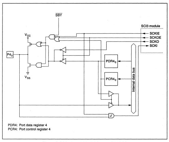
Figure C-4 (d) Port 4 Block Diagram (Pin  $P4_0$ )
