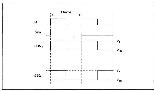
Figure 13-13 (d) Waveforms at Static Duty
