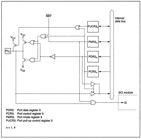
Figure C-3 (d) Port 3 Block Diagram (Pins P3<sub>4</sub> and P3<sub>1</sub>)
