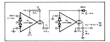
Figure 23. Tachometer
