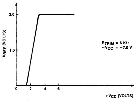
Figure 6. V<sub>REF</sub> vs. +V<sub>CC</sub>
