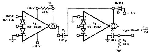
Figure 23. Tachometer
