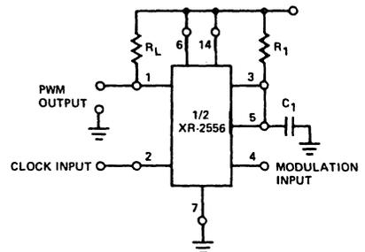
**Figure 27. Pulse-Width Modulation**
