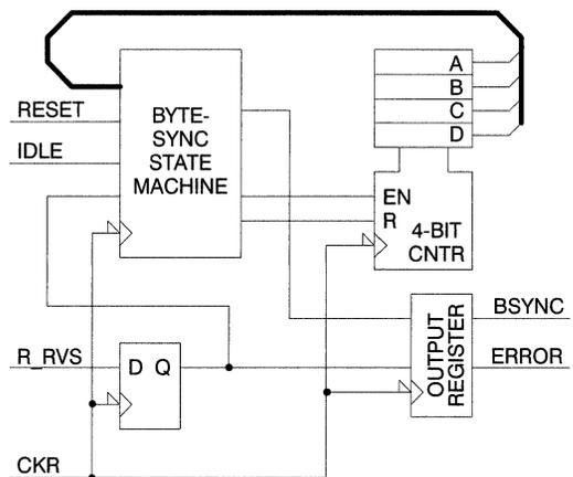
**Figure 11. Byte-Sync State Machine Block Diagram**
