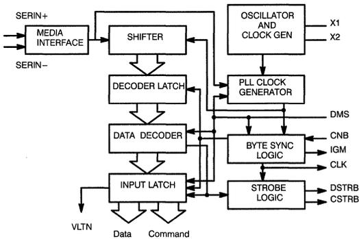
**Figure 6. Am7969 Logic Diagram**
