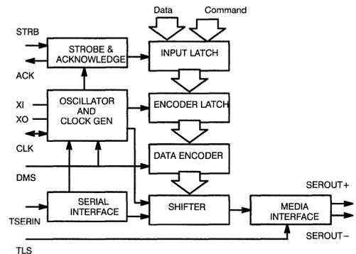
**Figure 5. Am7968 Logic Diagram**
