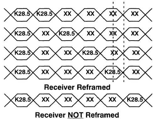
**Figure 10. Double-Byte Reframing**
