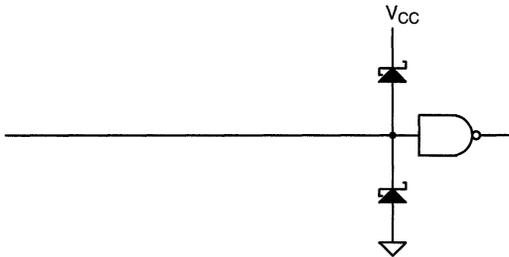
**Figure 19. Schottky Diode Termination**
