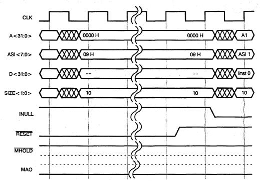
Figure 1. Power-On Reset Timing
