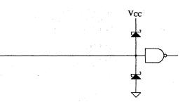
**Figure 19. Schottky Diode Termination**
