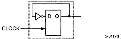
Figure 26. Toggle Flip-Flop
