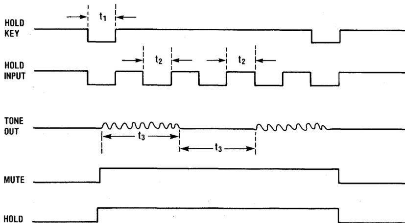
$t_1$ : 10ms MIN  $t_2$ : 100ms TYP  $t_3$ : 800ms TYP
