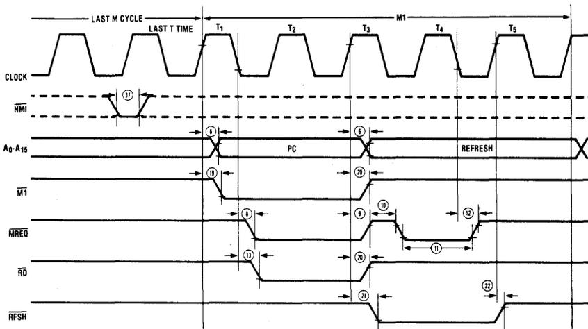
\* ALTHOUGH NMI IS AN ASYNCHRONOUS INPUT, TO GUARANTEE ITS BEING RECOGNIZED ON THE FOLLOWING MACHINE CYCLE, NMI'S FALLING EDGE MUST OCCUR NO LATER THAN THE RISING EDGE OF THE CLOCK CYCLE PRECEDING  $T_{\text{LAST}}$ .
