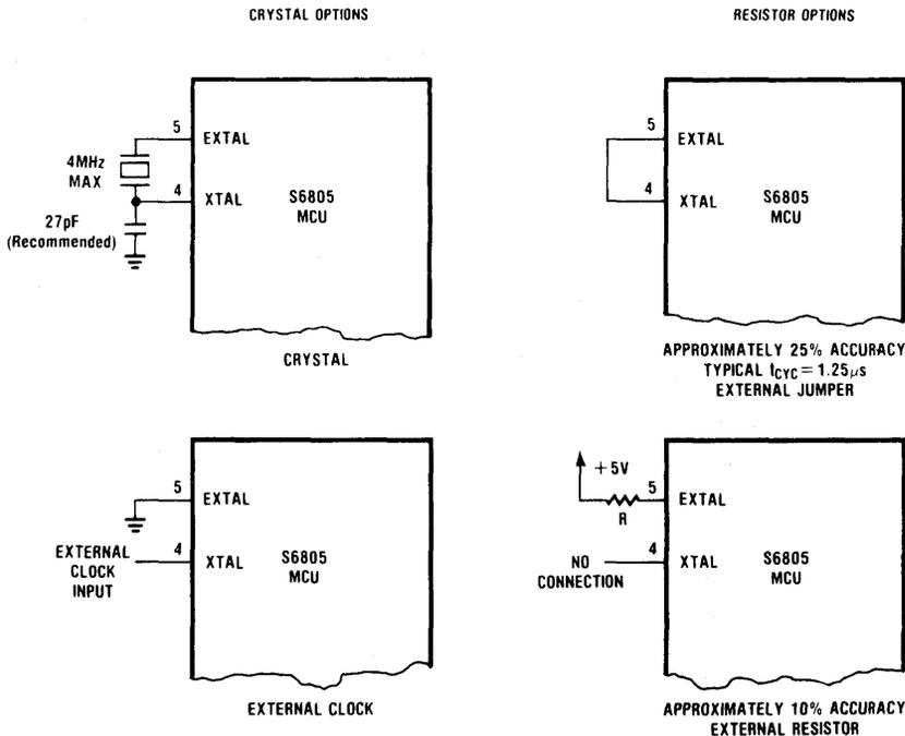
**Figure 14. Crystal Parameters**
