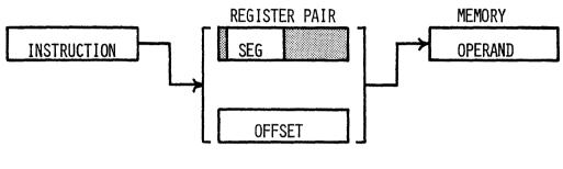
FIGURE 11 AMZ8001 INDIRECT REGISTER ADDRESSING MODE
