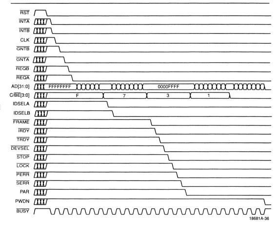
Figure 28. NAND Tree Waveform
