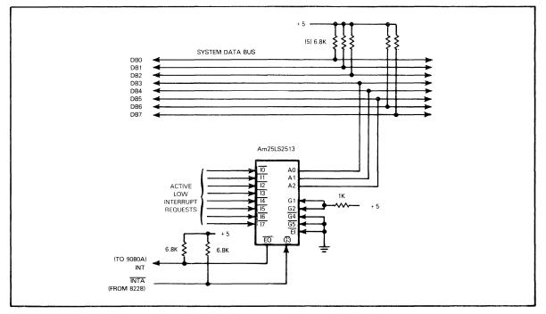
FIGURE 15-6 PRIORITY ENCODED RST INTERRUPT INSTRUCTION
