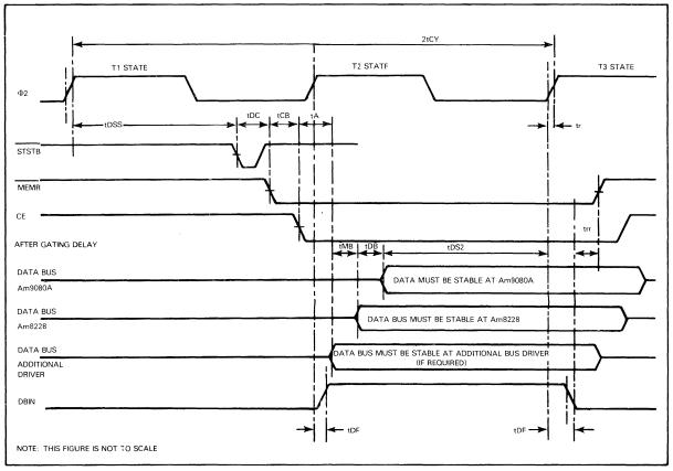
FIGURE 14-6 MEMORY READ OPERATION WITH CLOCKED MEMORIES
