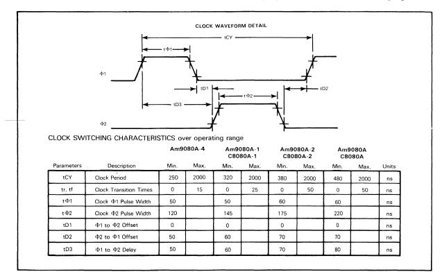
FIGURE 12-1 Am9080A CLOCK REQUIREMENTS
