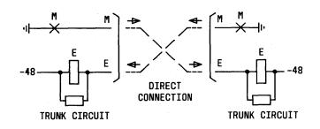
NOTE: THE FIGURE SHOWS SIGNALING CIRCUITS BACK-TO-BACK IF ALL E&M DESIGNATIONS ARE REVERSED.
